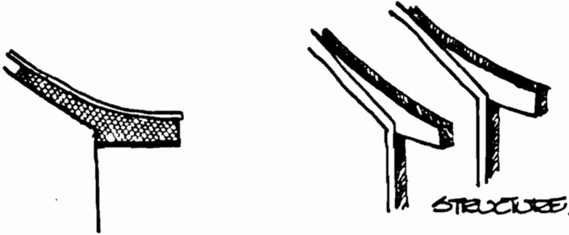
"Avant-toit à semelle": avant-toit obtenu quand le pied du chevron-arbalétrier s'appuie sur une semelle transversale, par rapport à la sablière, et une jambette. L'avant-toit à semelle donne un versant droit (voir ce mot).
