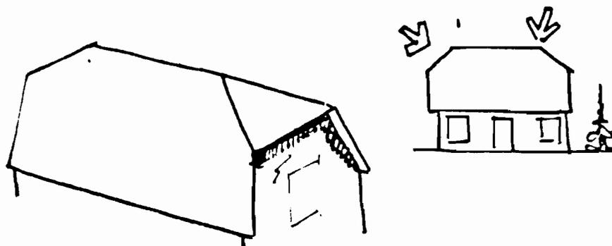
"Toit Mansard": toit brisé à deux pentes différentes: le terrasson, partie supérieure et le brisis, partie inférieure. Il peut être à deux versants et à pignons ou à quatre versants.
